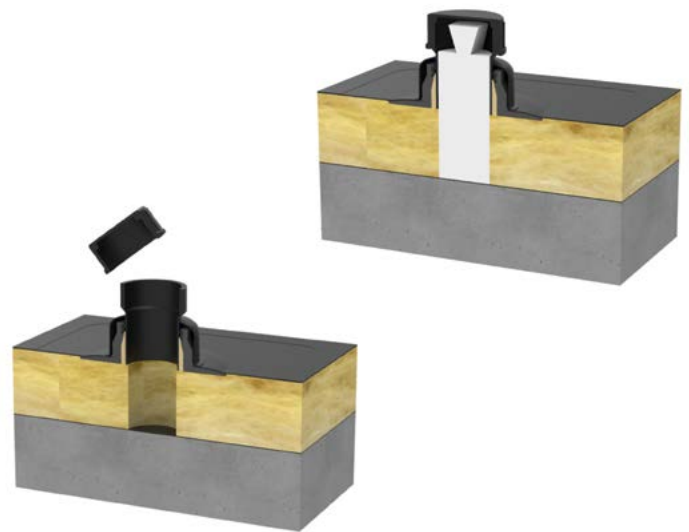
Auch als Kabeldurchführung nutzbar (Anwendungsbeispiel)
