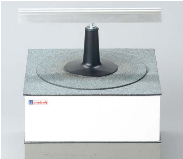
Befestigungsdurchführung aus PUR (schwarz) wärmegeklämt, FCKW-frei, mit integrierter Gummidichtung und eingeschäumter Anschlussbahn (Bitumen, PVC oder Sonderfolie).
